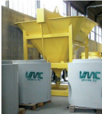
Bir beton teknesiyle yalnızca C60/75 sınıfı beton, Perfect-ürünler için döküm kalıplarına dökülmektedir.
