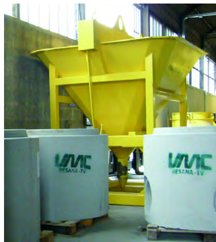
Данный бункер используется для заливки бетонной смеси класса C60/75 в формы Perfect
