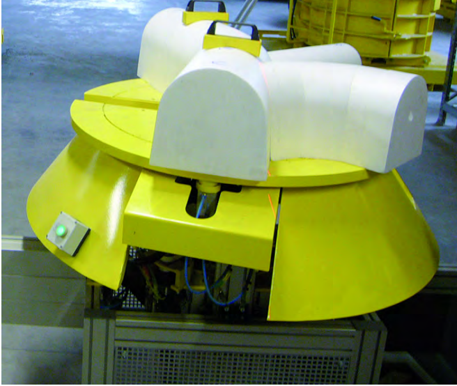
На заводе VMC с помощью специальных программно управляемых пил формируют EPS-вставки для водоводов
