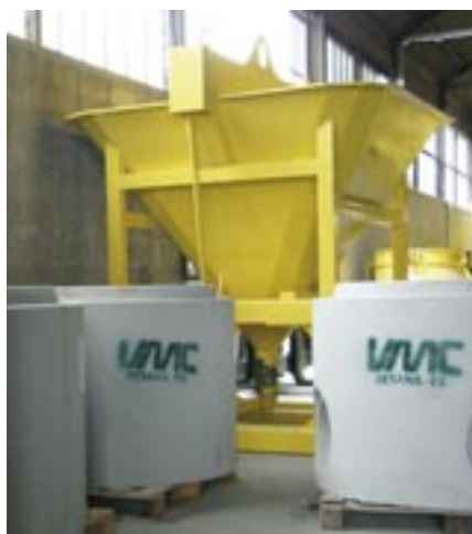
Silos służy wyłącznie do zalewania form Perfect betonem klasy C 60/70.
