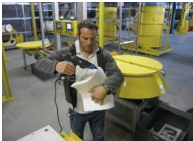
Przycinanie kształtek na wycinarkach i ich montaż w negatyw kinety trwa zaledwie kilka minut.
