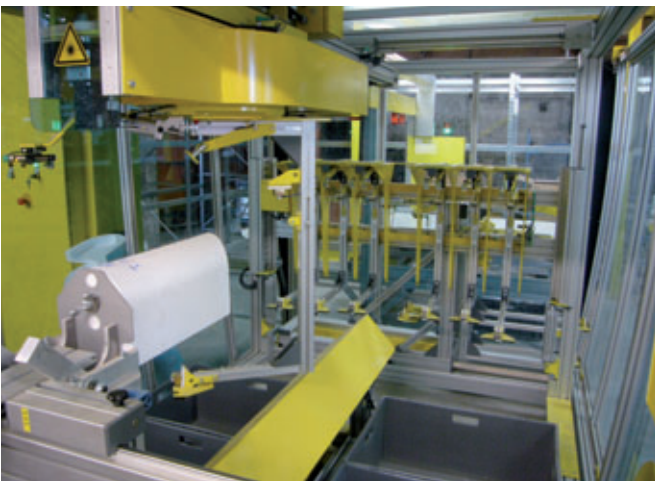
La découpe des canaux avec des scies à fil incandescentes et l'assemblage des matrices en négatif se font en quelques minutes.
