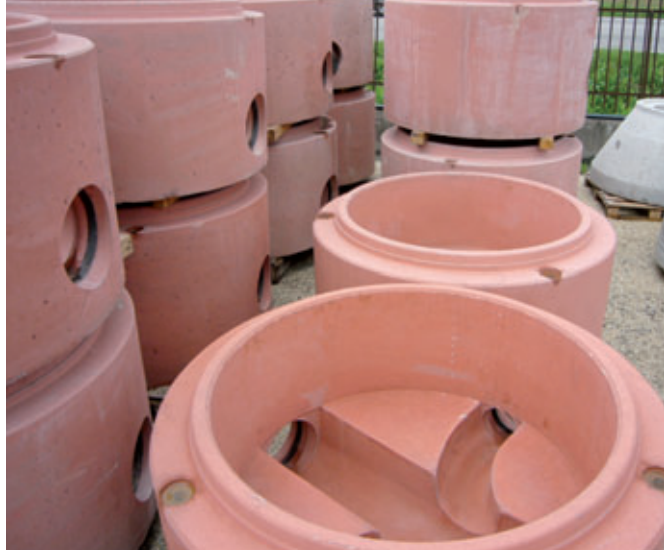
Tanto los pozos redondos como los ovalados cuentan con anillos de estanqueidad integrados.
