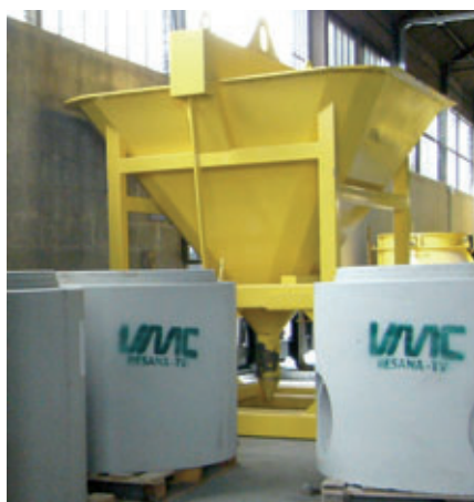
Con una cubeta de hormigón, se llenan los moldes con hormigón exclusivamente de la clase C60/75 para los productos Perfect.
