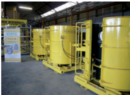
En esta zona adaptada de la nave se fabrican desde comienzos de 2011 bases de pozo Perfect monolíticas.
