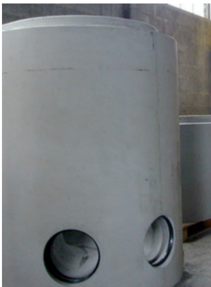
Die Qualität der schalungserhärteten Bauteile ist augenscheinlich – makellose Oberfläche von der Gerinnesohle bis in das Spitzende.
