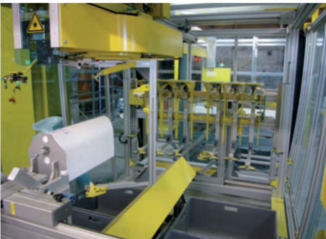
Der Zuschnitt der Gerinneteile mit Heißdrahtsägen und das Zusammensetzen zum Negativgerinne erfolgt binnen weniger Minuten.
