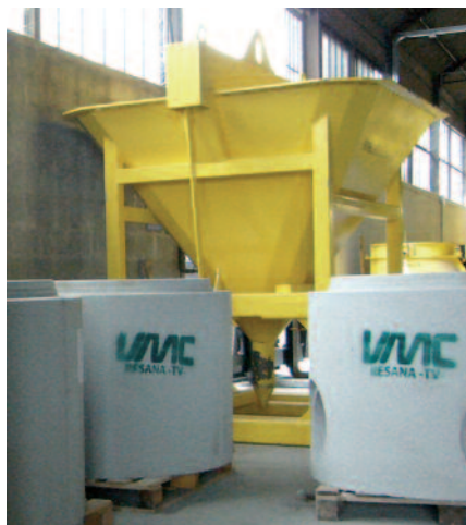
Uma caçamba de concreto traz somente concreto de classe C60/75 para os moldes de produtos Perfect
