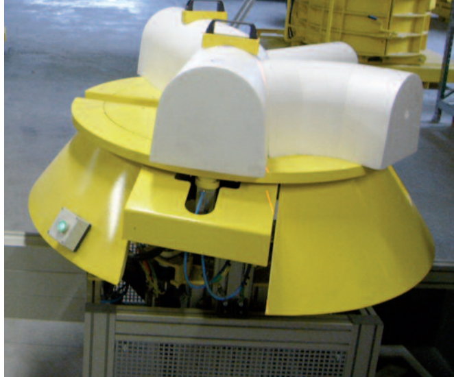
Na VMC, um cortador elétrico é utilizado para cortar as peças de EPS com economia de material para atender as necessidades do seu projeto; a foto mostra a serra para moldar as margens
