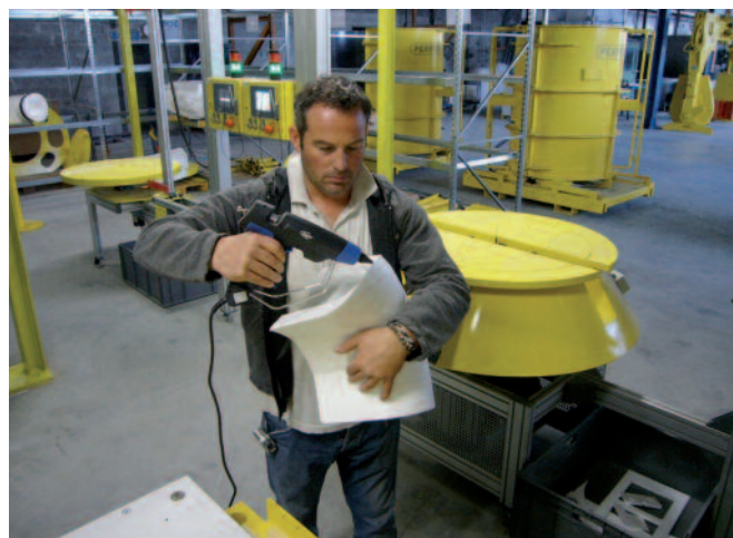
As seções de canal são cortadas com um cortador elétrico e os canais negativos são unidos em apenas alguns minutos
